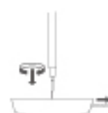
① ランプシェードを差し込み、リングを調節してランプシェードを固定します。
